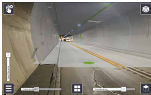
Slika 3: Prekrivanje IFC modela zahodne predorske cevi predora Karavanke z dejanskim stanjem.
