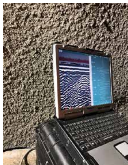
Slika 1: Izvedba georadarskih meritev v vrtini (vir: lastni arhiv). Figure 1: Borehole georadar survey (source: author's archive)
