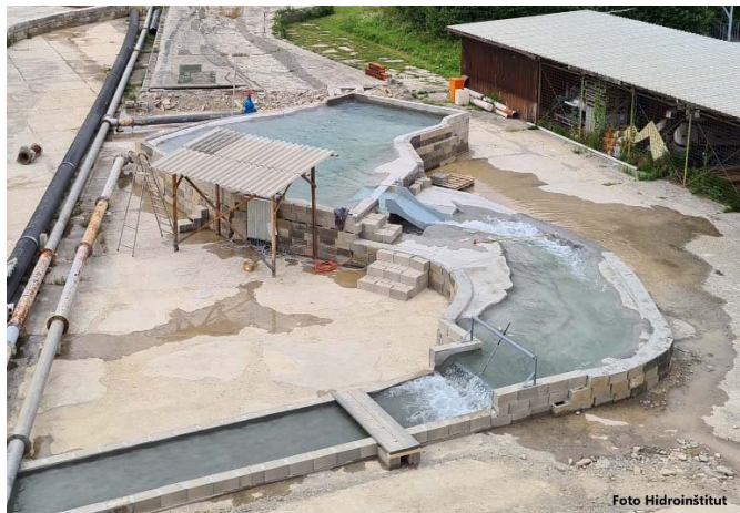
Slika 4: Fizični hidravlični model pregrade Pod Sušo v merilu 1:25, izdelan na zunanji laboratorijski ploščadi Inštituta za hidravlične raziskave (Foto: Jurij Mlačnik)
