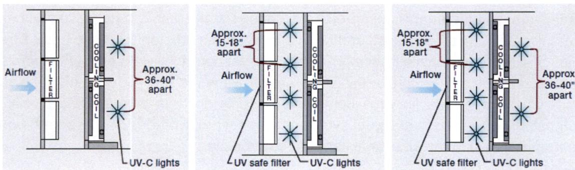
SI.4: Postavitev UV-C svetilk v prezračevalni napravi. Levo: Izhodna stran hladilnega prenosnika toplote za dezinfekcijo prenosne površine hladilnika. Srednja: Vhodna stran hladilnega prenosnika toplote za dezinfekcijo zračnega toka. Desna: Vhodna in izhodna stran hladilnega prenosnika toplote za dezinfekcijo tako zračnega toka kot prenosnih površin hladilnika.<sup>6</sup>
