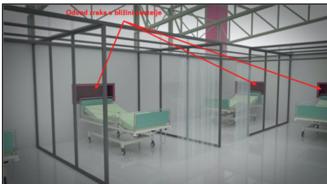
Slika 3: Odvod zraka v neposredni bližini postelj bolnikov
