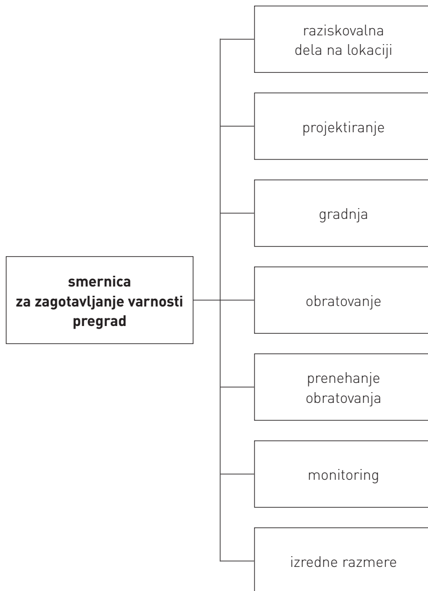
Slika 5: Vsebina smernice za zagotavljanje varnosti pregradnih objektov
